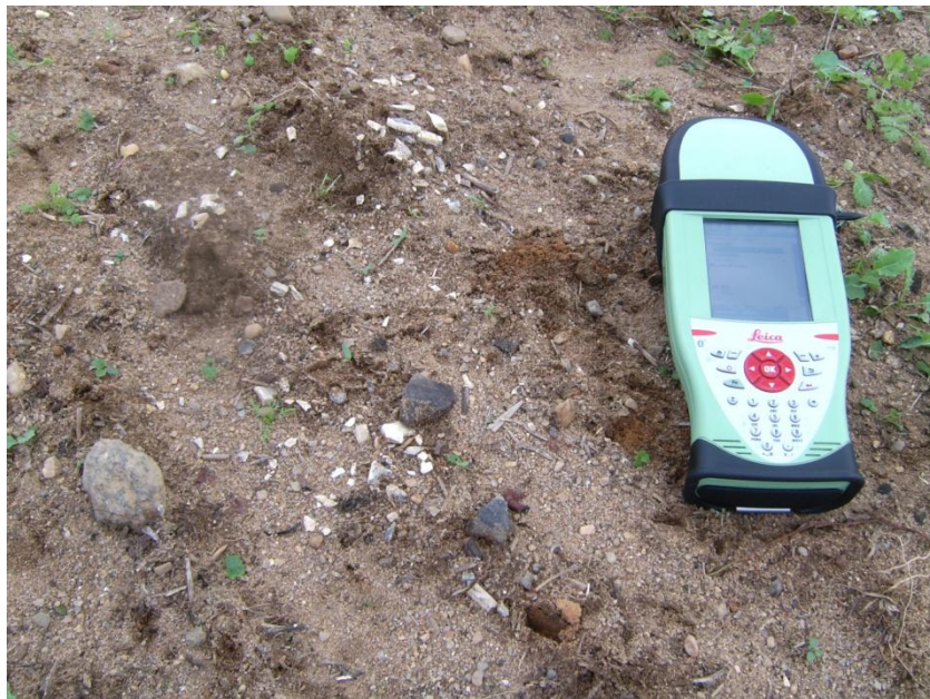
Abb. 1: Fundeinmessung mit DGPS (Foto: F. Nikulka)
