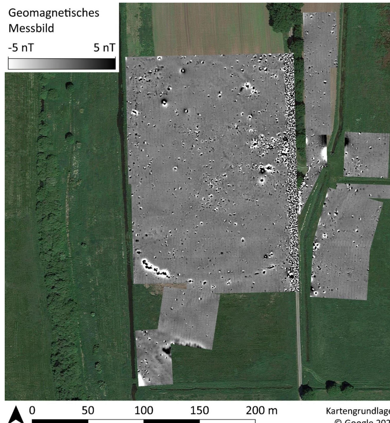
Geomagnetisches Messbild mit erkennbarem Verlauf der Gräben (Grafik L. Eckert, VFGA/Uni HH)
